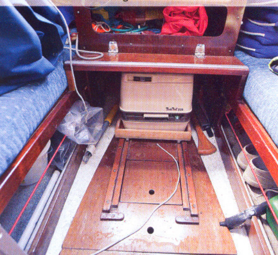
En campingtoalett på skenor är en hemmasnickrad lösning.
